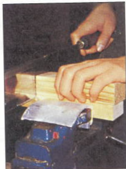
Im Schraubstock mit Holzklötz als Hilfsanschlag
