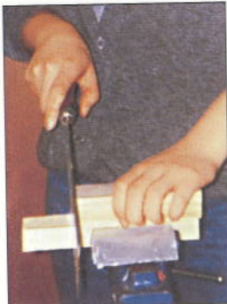
Im Schraubstock mit Holzklötz als Hilfsanschlag
