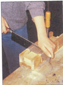
Sägen mit der Schneidlade (Gehrungslade)
