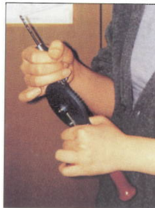
Einsetzen des Bohrers
