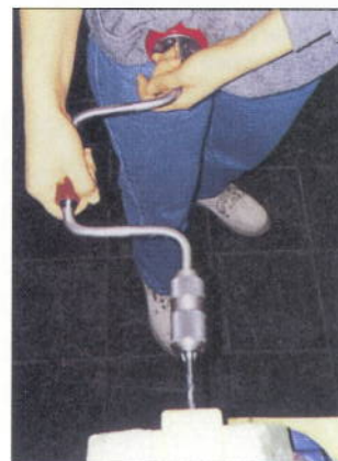
Waagrechtes Bohren mit einer Bohrwinde
