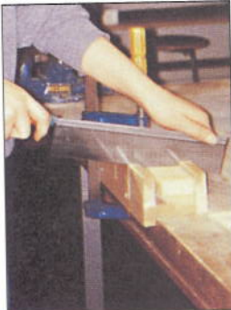
Sägen mit der Schneidlade (Gehrungslade)
